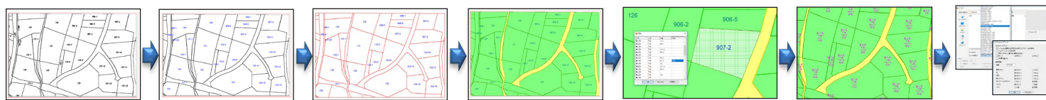
①座標付け ②地番文字をOCR ③区画線をベクター化、トポロジー構造の作成 ④ポリゴン生成 ⑤属性付与 ⑥ラベル付け ⑦SHP出力
