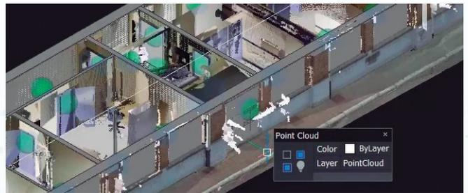
点群にすでに存在するメタデータを活用して、Hexagon Smart Point Cloud形式で読み込む際に、領域、スキャン位置、分類でスキャンをフィルタリングします。
